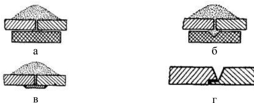
Рис. 13.7. Подкладки для сварки стыковых швов: а – медные; б – флюсомедные; в – остающиеся; г – полка в одном из листов
