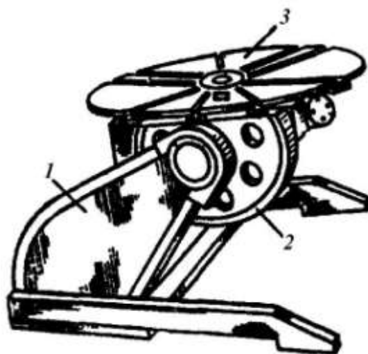
Рис. 20.2. Сварочный манипулятор: 1 – основание; 2 – привод вращения; 3 – стол
