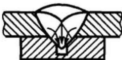
Рис. 17.1. Подкладка для сварки алюминиевых сплавов
