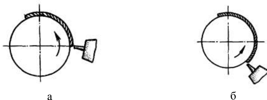
Рис. 15.3. Расположение горелки при выполнении кольцевых швов: а – сверху вниз; б – полупотолочное
