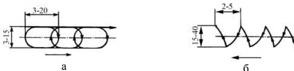
Рис. 15.4. Колебательные движения электрода при сварке порошковой проволокой: а – по спирали; б – змейкой
